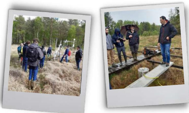
Présentation de la tour Eddy Covariance (à gauche) et des chambres d'accumulation (à droite), deux dispositifs permettant de mesurer les flux de GES
