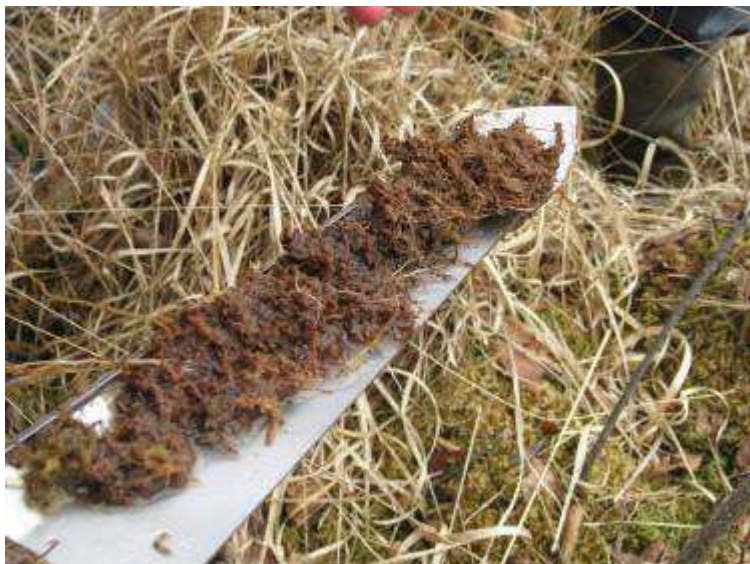
Le résultat d'un carottage en partie ouest de la tourbière de la Lioche. Le matériau extrait est très fibrique. Photo F. Muller
